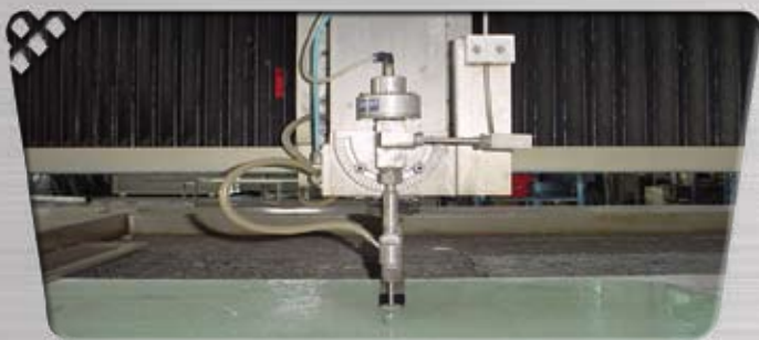
Taglio ad acqua con tecnologia waterjet, dimensioni 3.000 x 1.600 fino ad uno spessore di 100 mm
