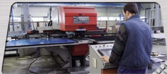
Punzonatura C.N.C. su formato 1.500 x 6.000 max 5 mm (Fe430)
