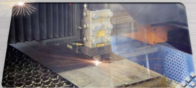
Taglio laser con dimensioni massime 4.000 x 2.000 e fino ad uno spessore di 25 mm su acciaio al carbonio e 15 mm su inox
