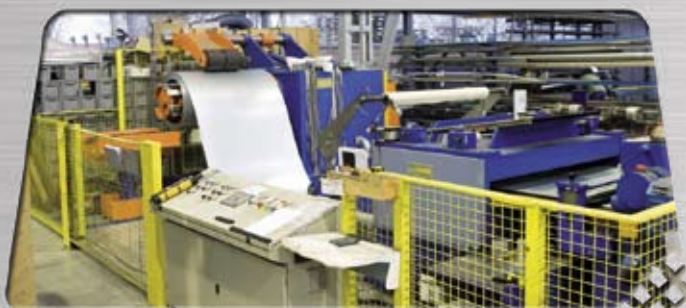
Spianatura da coils su lega di alluminio e lamiera fino a 2 mm
